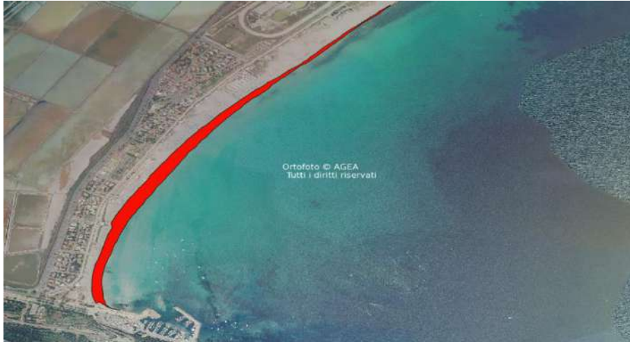
Figura 46, risultato erosione spiaggia Poetto dal 2003 al 2019.
